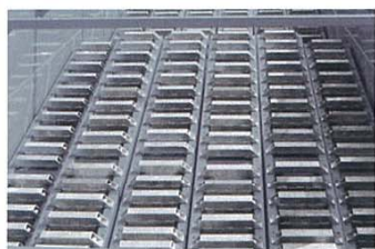
スクリーン面 鋼製パドルの広い選別面
