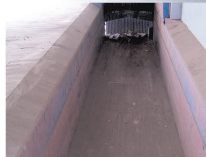
HWSS-2000-IV(1000TON) フィーディングボックス 深くて頑強な投入ボックス。
